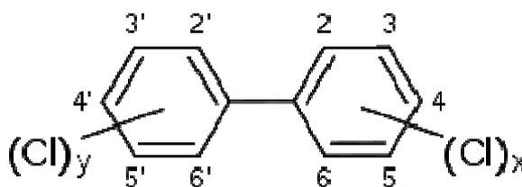
El uso de los PCBs se dio en la industria de equipos eléctricos como fluidos dieléctricos e hidráulicos, como modificadores de aceite, fluido de intercambio de calor y en bombas de vacío, también como impregnadores de resistencias de carbón y como selladores en agentes impregnantes en sistemas eléctricos, debido a su gran estabilidad térmica e ininflamabilidad.
